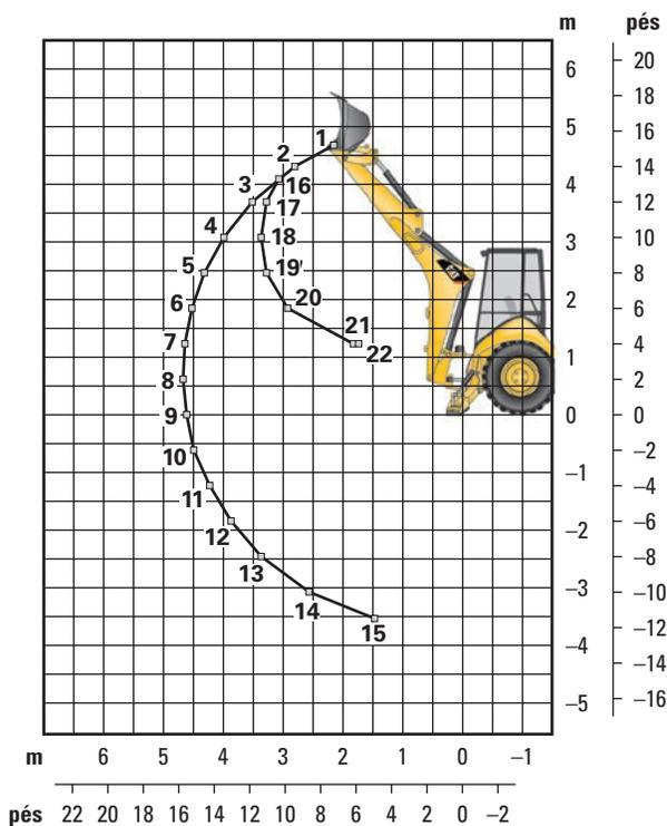
As capacidades de levantamento são valores sobre a traseira. Máquina equipada com Tração nas 4 Rodas, OROPS, caçamba de aplicações gerais de 0,96 m<sup>3</sup> (1,25 jd<sup>3</sup>) e contrapeso de 116 kg (255 lb).
