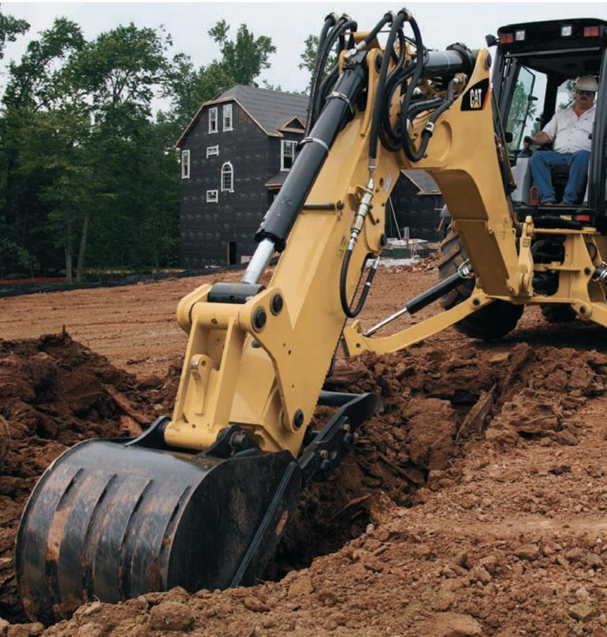
A 420E tem um sistema hidráulico de centro fechado e sensível a carga que ajusta a potência e o fluxo à demanda dos implementos. Então, se você está no modo de valetamento de produção ou escavando delicadamente ao redor de um obstáculo, você está no controle. Em aplicações como valetamento de produção, a velocidade é importante e o sistema ajustará o fluxo necessário para que o trabalho seja feito rápida e eficientemente. O sistema hidráulico sensível à carga também proporciona:
